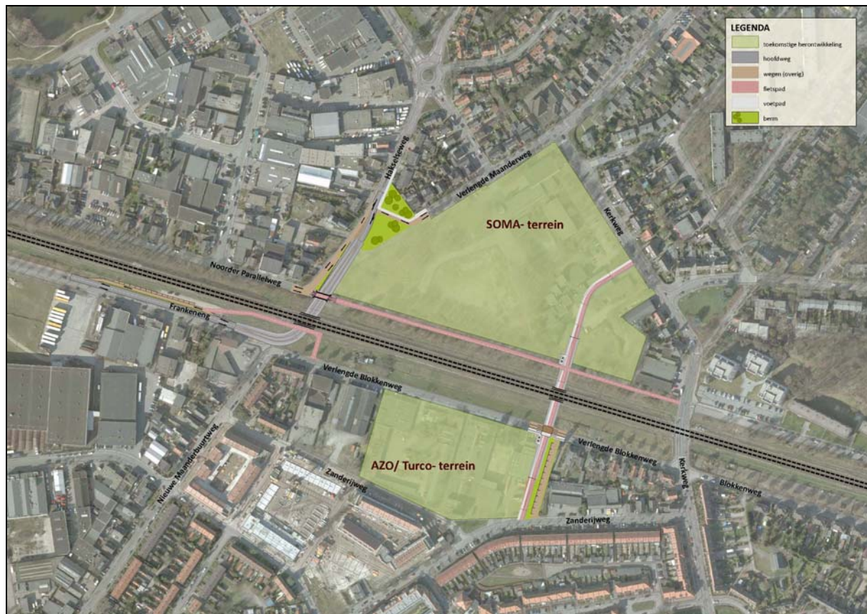
Figuur 2: Ontwerp nieuwe situatie met ongelijkvloerse spoorwegovergangen
