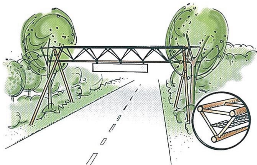
Figuur 10. Voor passage van boommarters en eekhoorns aangepast portaal (bron: Kruidering et al. 2005).
