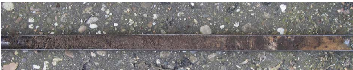
Figuur 12: Foto van boring 3 met daarop duidelijk zichtbaar de zeer rommelige opbouw van het met brokken schoon zand vermengde pakket humusrijk zand. Duidelijk is ook te zien dat de bodem hier tot in de C-horizont (het gele zand rechts), is doorgraven.
