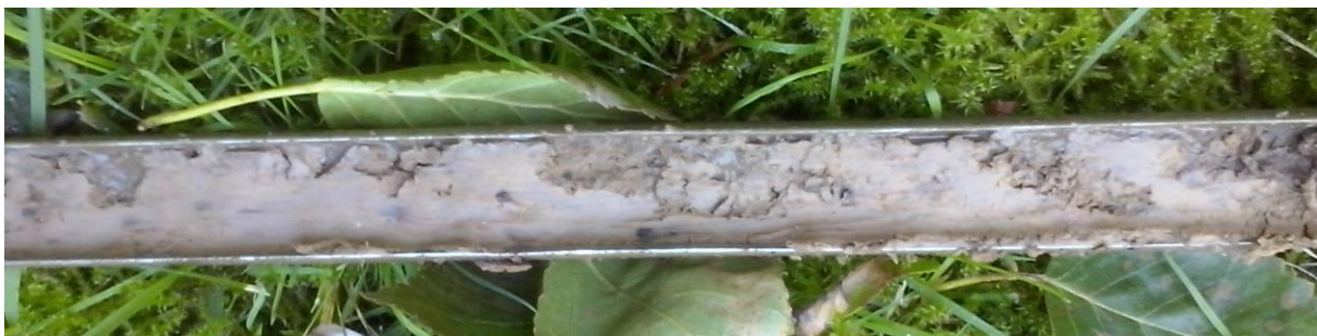
Figuur 15: Foto van de vegetatiehorizont (links van het midden) zoals deze is aangetroffen in de boringen 1, 2 en 5 met daarin mangaan-concreties (de donkere vlekjes).
