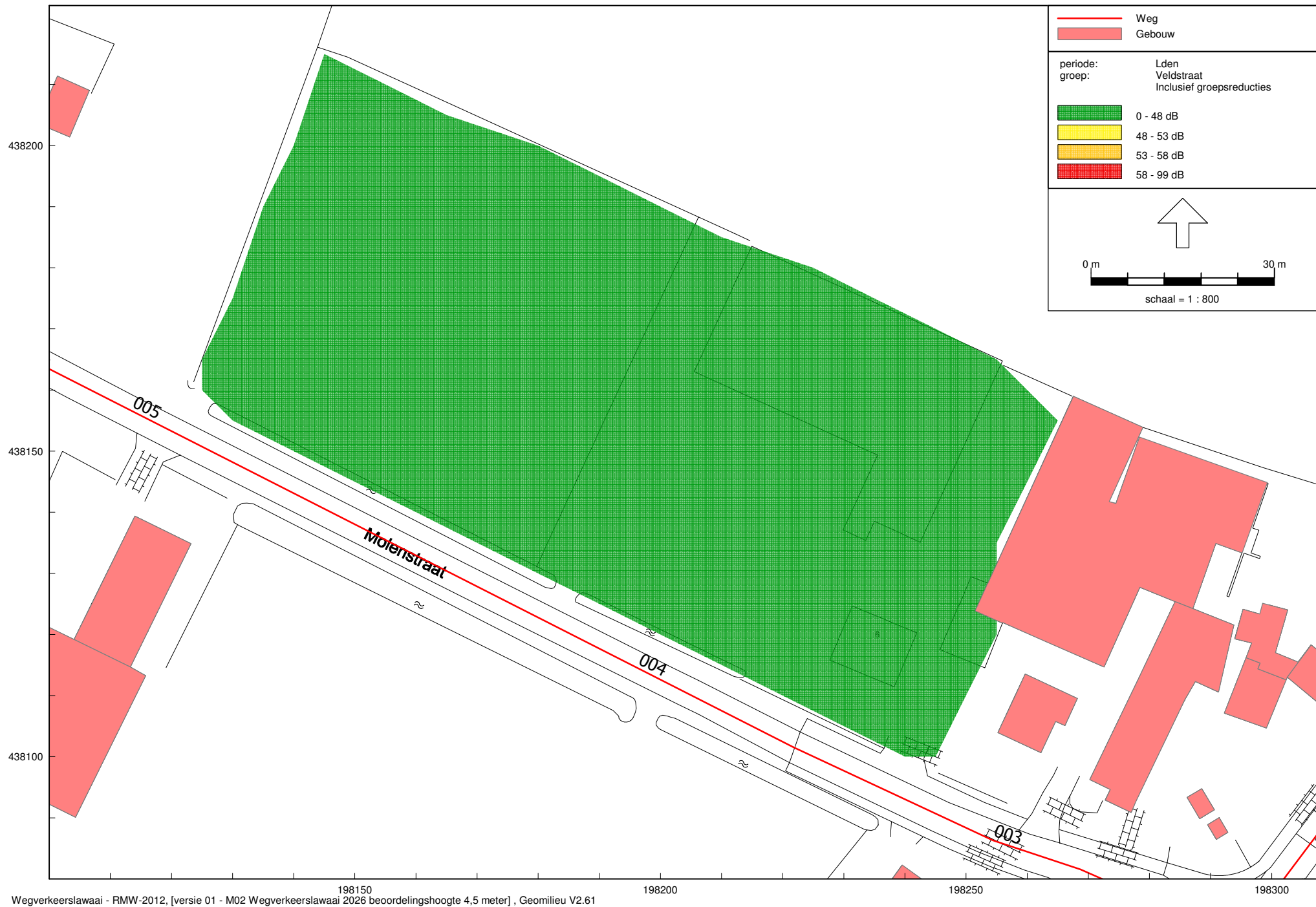
Figuur 6 Ligging geluidscontouren ten gevolge van wegverkeer op de Veldstraat op 4,5 meter hoogte
