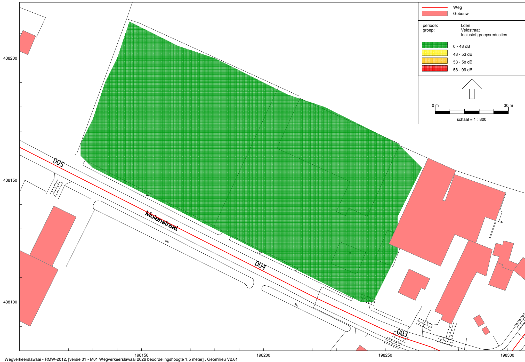
Figuur 3 Ligging geluidscontouren ten gevolge van wegverkeer op de Veldstraat op 1,5 meter hoogte
