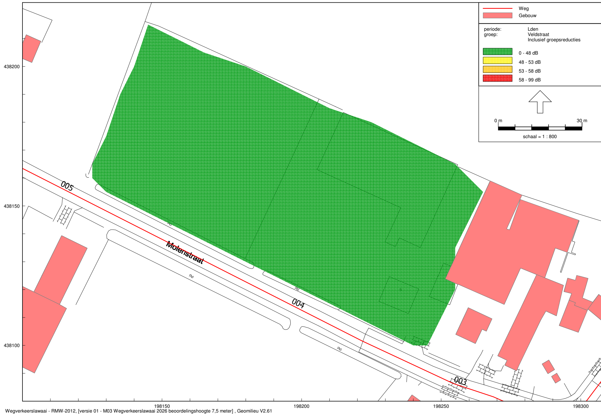
Figuur 9 Ligging geluidscontouren ten gevolge van wegverkeer op de Veldstraat op 7,5 meter hoogte
