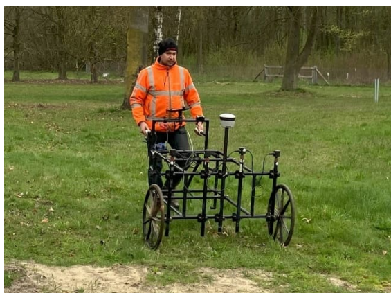
Figuur 3. Passieve non realtime oppervlakedetectie met het Vallon Multisondesysteem VXV4 en een staafdiagram waarop het maximale detectiebereik ( m^2 – maaiveld) per kaliber.
