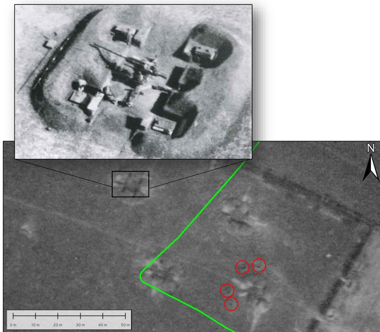
Figuur 22: opnieuw de luchtfoto waarop de vuuropstellingen voor het luchtafweergeschut zichtbaar zijn. De ingevoegde afbeelding erboven toont een dergelijke opstelling in meer detail. In de rode cirkels zijn onderkomens/munitienissen aangelegd, die hieronder worden weergegeven. Bron: Wolfgang Fleischer, Feldbefestigungen des deutschen Heeres (z.j. Eggolsheim).
