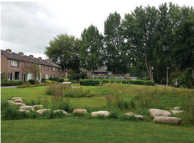
waterberging combineren met spelaanleidingen
