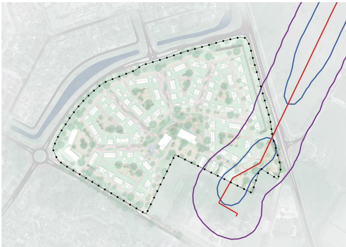
Afbeelding 4.3: Plaatsgebonden risico voor gasleiding N-559 - blauwe contour = PR 10^{-7} en paarse contour = PR 10^{-8}
