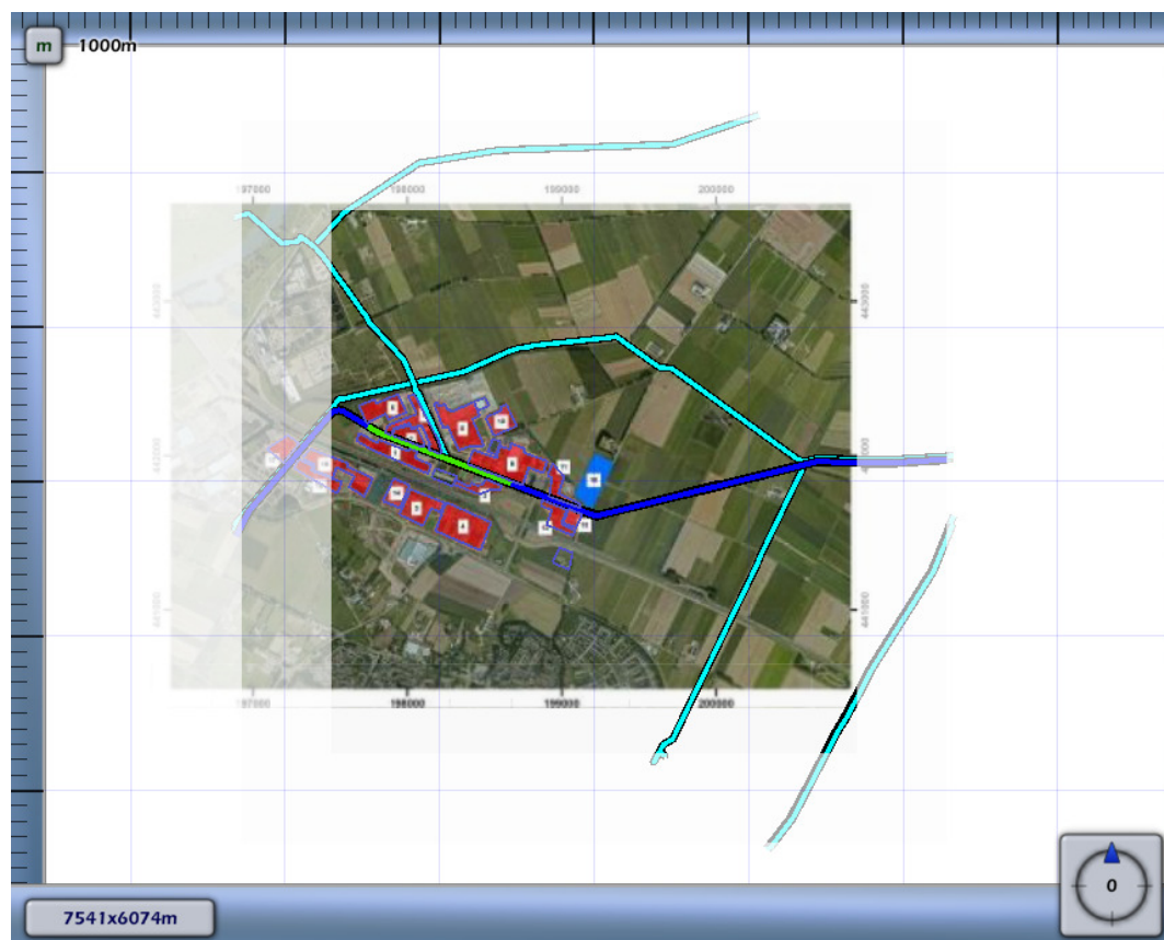
Figuur 4.2 Kilometer leiding behorende bij de maximale overschrijding van de FN-curve voor A-505 van N.V. Nederlandse Gasunie
