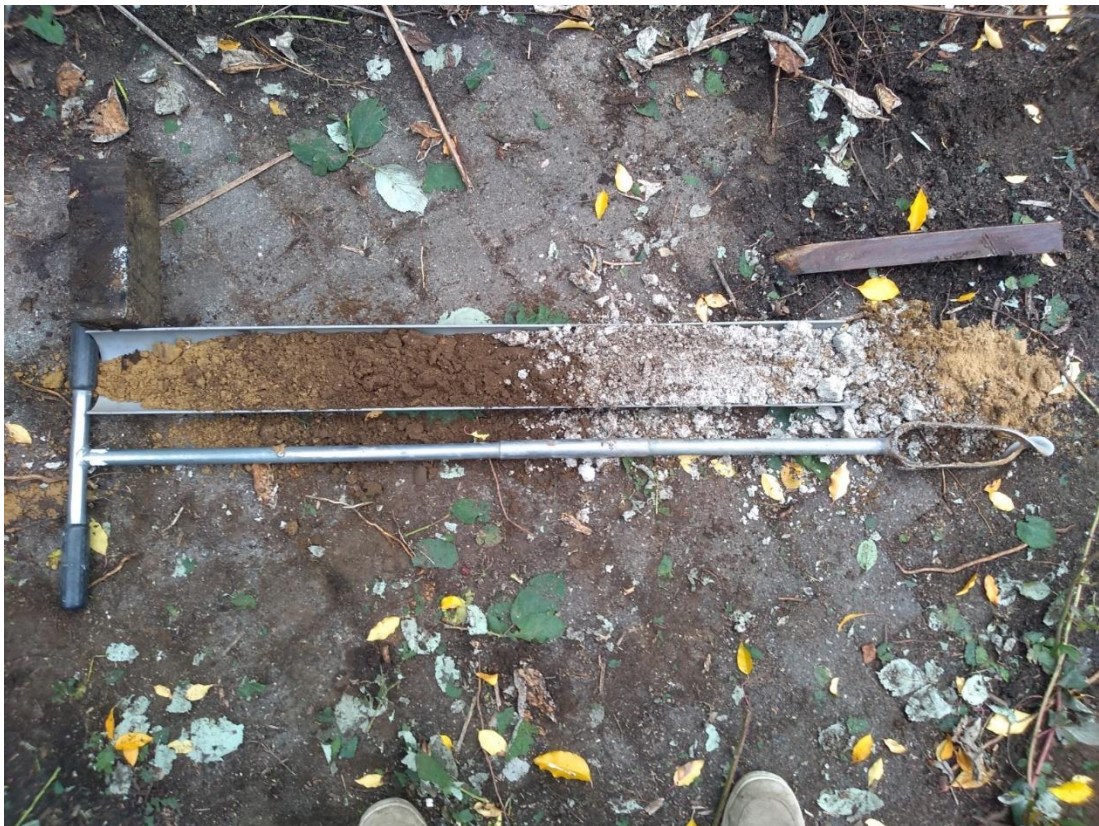
Afbeelding 10: Foto van de boorkern van boring 1 met vanaf 65 cm-mv tot op het dekzand (115 cm-mv) een kenmerkende witte laag van gebrande kalk met zand.
