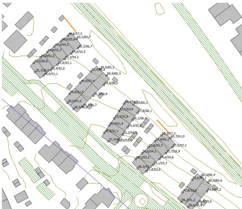
Figuur 4.1: geluidbelasting ten gevolge van het railverkeer incl. de tuilmuren met een hoogte van 1,8 m (oranje lijn)
