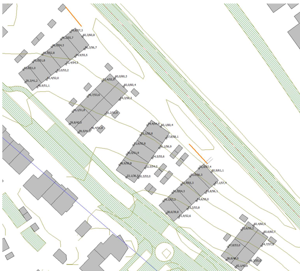
Figuur 4.1: geluidbelasting ten gevolge van het railverkeer incl. de tuinmuren met een hoogte van 1,8 m (oranje lijn)
