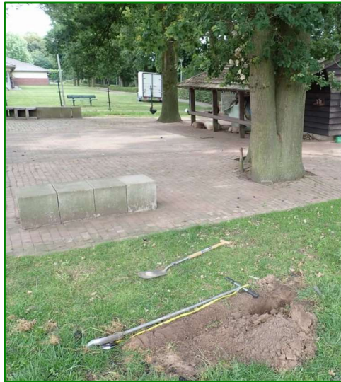
Foto 2: schraal zand in de proefsleuf bij boom 69, ter hoogte van de gevellijn
