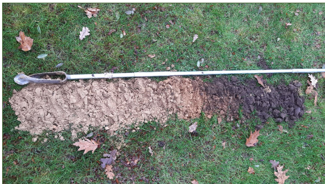
Figuur 11 Grondboring tot 1,5 m-mv uitgevoerd met een duidelijke toplaag van 60cm humeus zand.
