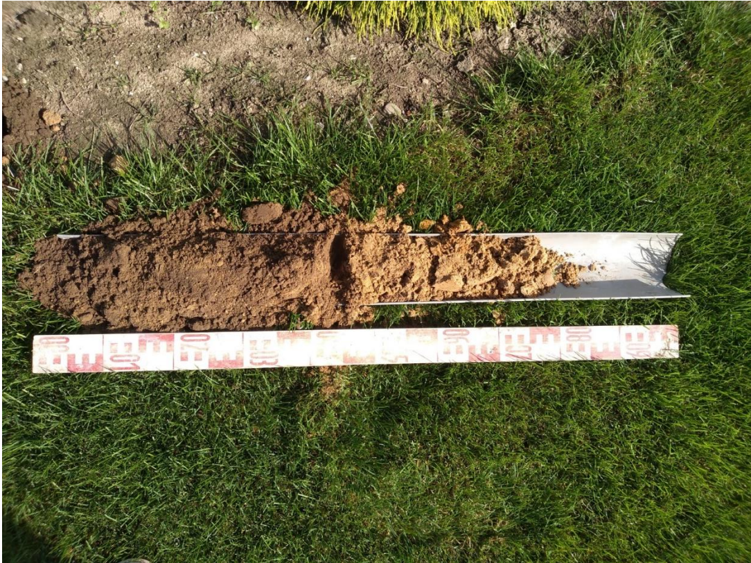
Afbeelding 11: Foto van het boorprofiel van boring 6 met tot 40 cm-mv een moderne bouwvoor van grijsbruin gevlekt zand die scherp overgaat in het onderliggende gele dekzand.
