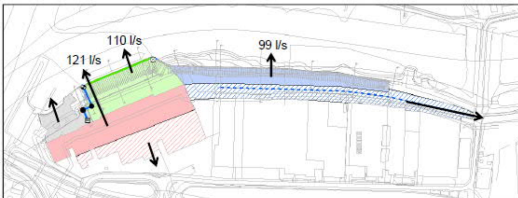
Figuur 2 Overzicht van de hemelwaterstructuur; de gevulde vlakken lozen op de IJssel en de vlakken met gestreepte arcering zijn aangesloten op de riolering. Bij de op de IJssel afwaterende gedeelten is het debiet vermeld bij bui 08.
