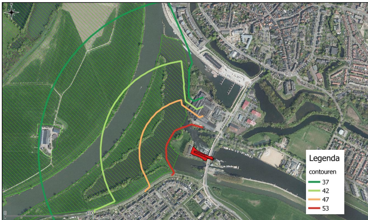
Figuur 13. Contouren geluid bij plaatsing machines in vrije veld (geen beschutting door loods). De 47 dB contour ligt binnen het Natura 2000-gebied (potentieel verstorend).
