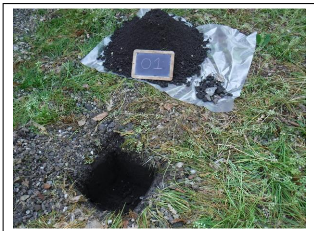
Foto: Inspectiegat bij boorpunt 01
