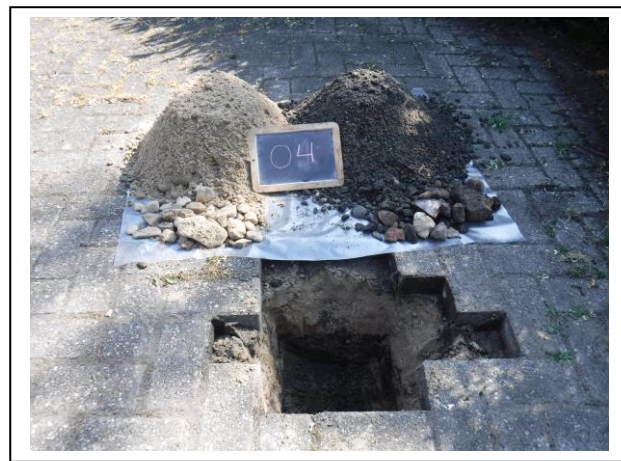
Foto: Inspectiegat bij boorpunt 04
