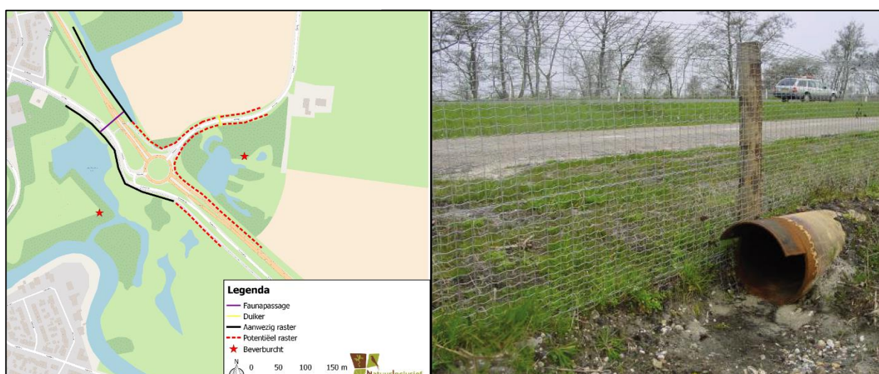
Figuur 4 en 5 Links: overzicht aanleg van rasters (rood) met eco-duikers (geel). Rechts: voorbeeld raster incl. overhang (foto: E. van der Grift, 2011).
