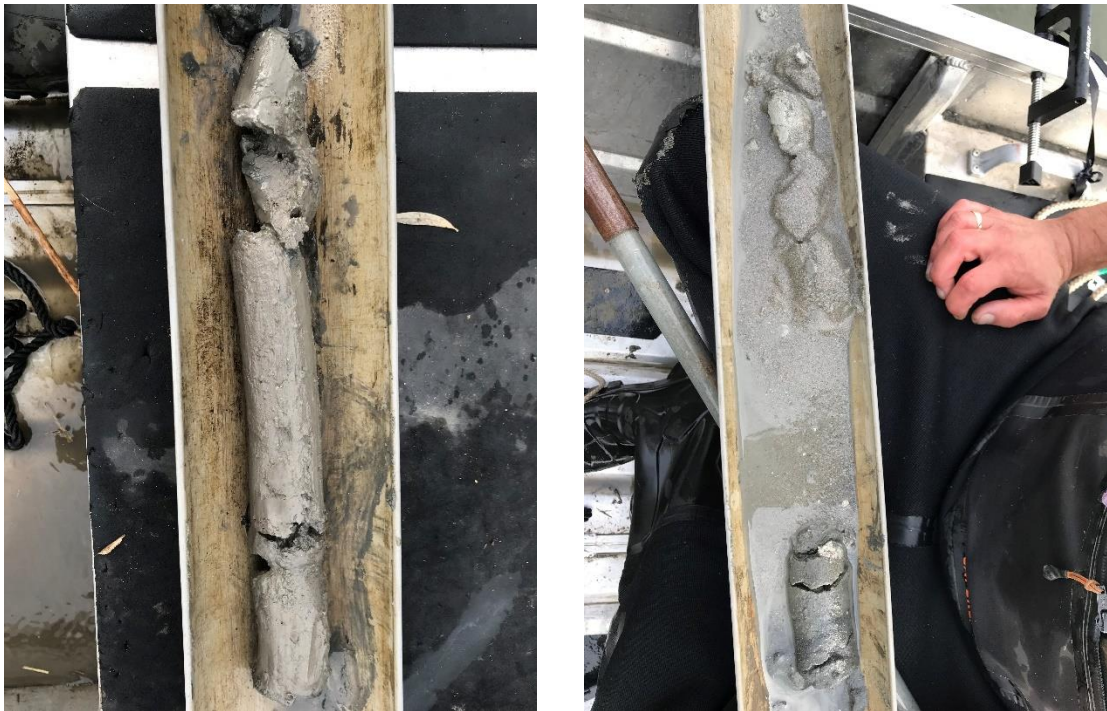
Afbeelding 3 Links: Boormonster (boorpunt 2) wat volledig bestaat uit klei. Rechts een gemengd boormonster (boorpunt 4) wat bestaat uit zand en klei.
