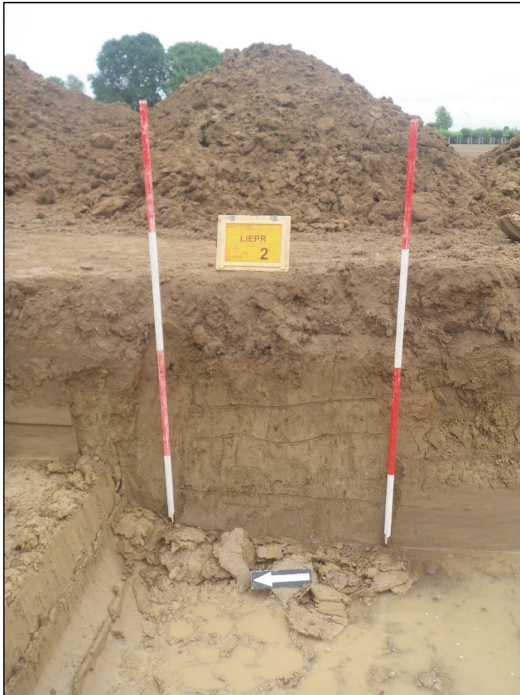
Afbeelding 9: foto van profiel 5. Hierbij is een zelfde soort opbouw zichtbaar als in profiel 1 (afbeelding 8) behalve de onderste laag. Dit betreft de komafzettingen.
