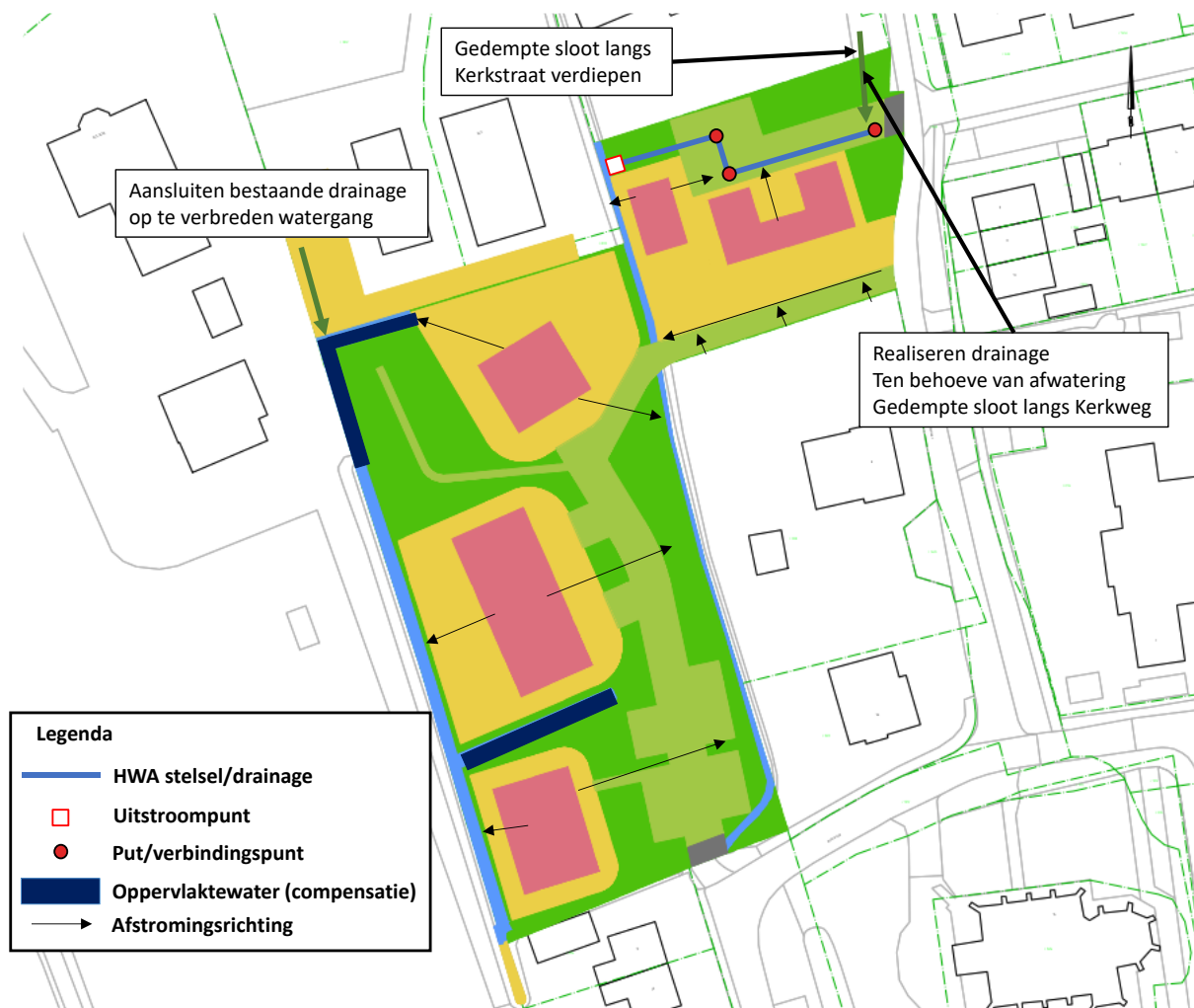
figuur 6 Overzicht HWA stelsel
