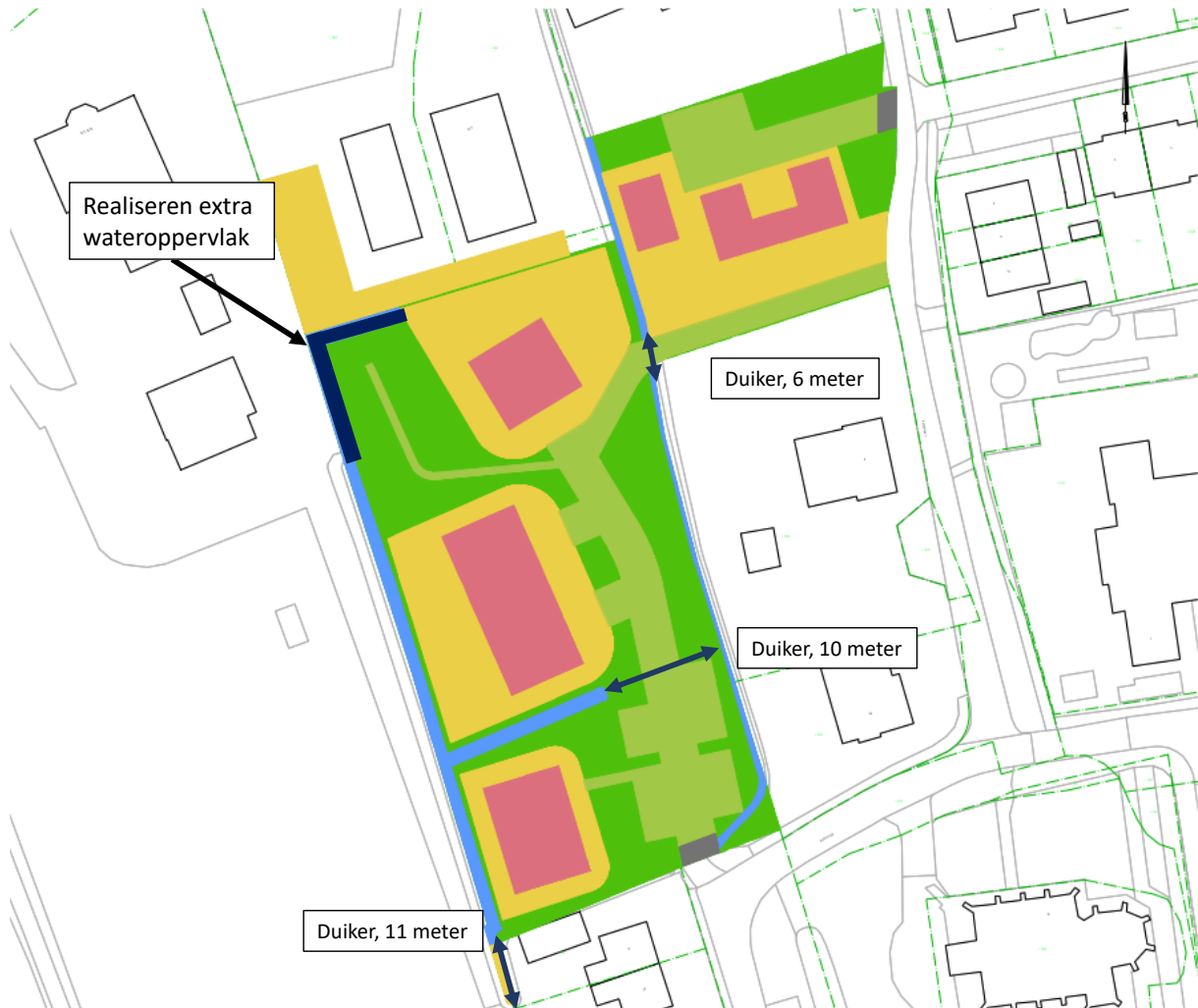
figuur 8 Situering te realiseren oppervlaktewater en duikers
