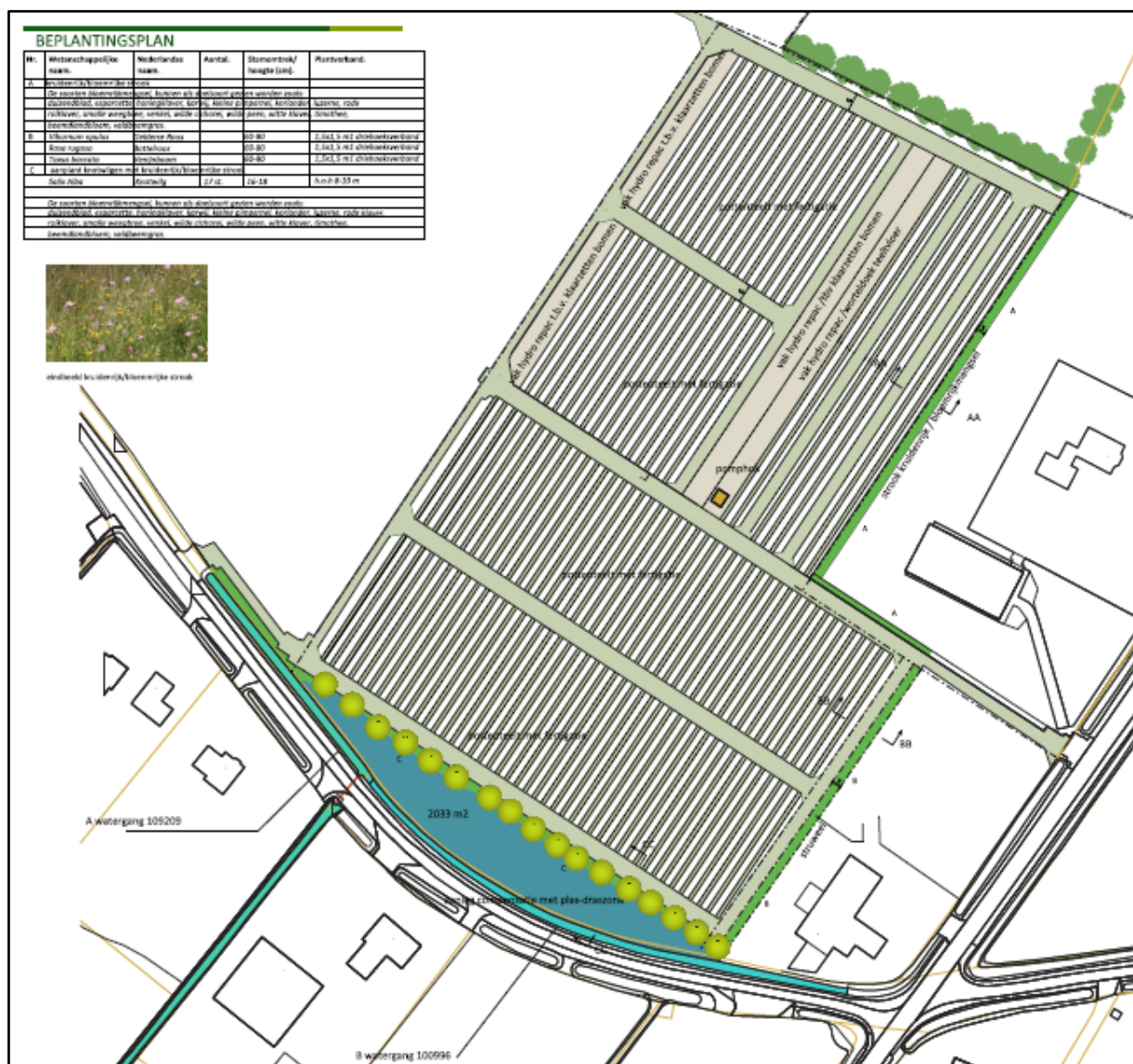
Afbeelding 2.2.1 Schematische weergave van de opzet van het pottenveld.
