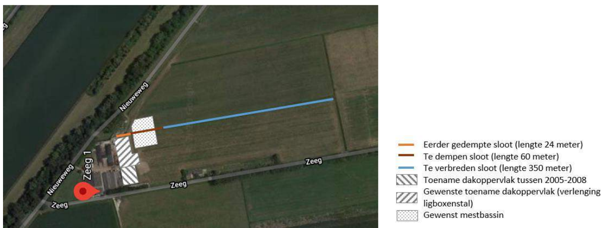
Figuur 4.6 Luchtfoto plangebied met hierop de waterbergingsvoorziening
