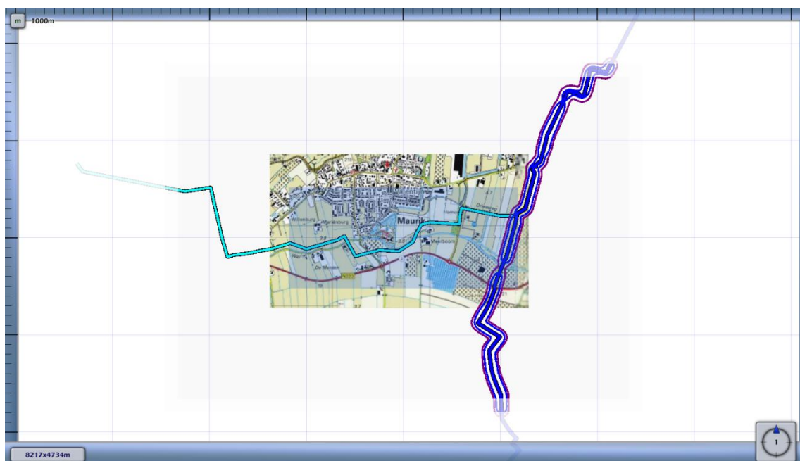
3.2 Figuur 3.2 Plaatsgebonden risico voor 8889_leiding-W-526-01-deel-1 van N.V. Nederlandse Gasunie
