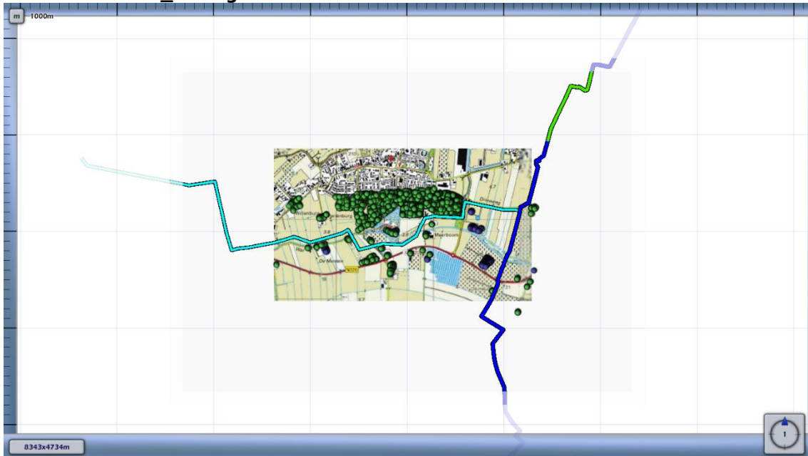
Figuur 4.2 Kilometer leiding behorende bij de maximale overschrijding van de FN-curve voor 8889_leiding-W-526-01-deel-1 van N.V. Nederlandse Gasunie
