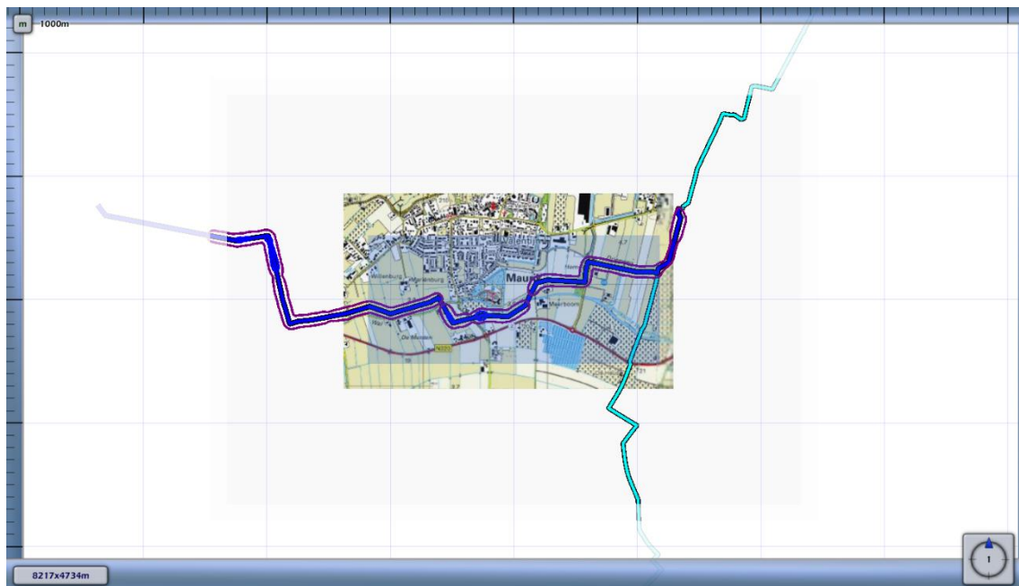
3.2 Figuur 3.2 Plaatsgebonden risico voor 8889_leiding-W-526-01-deel-1 van N.V. Nederlandse Gasunie
