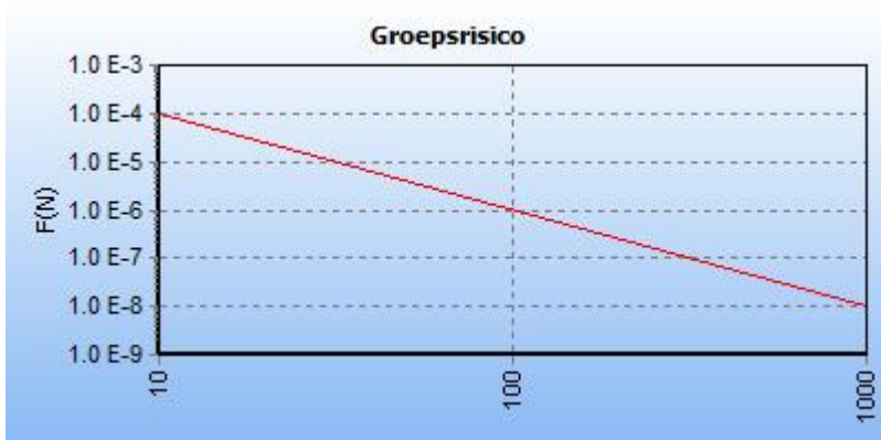
5.2 Figuur 5.2 FN curve voor 8889_leiding-W-526-01-deel-1 van N.V. Nederlandse Gasunie voor de kilometer tussen stationing 1360.00 en stationing 2360.00
