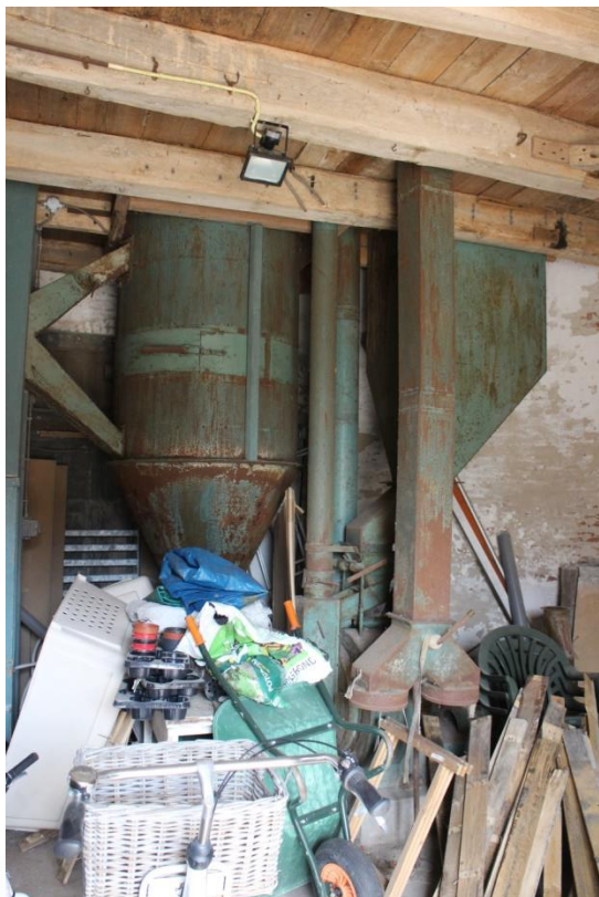
Stalen onderdelen van de maalinstallatie uit de jaren zestig onderin de molen
