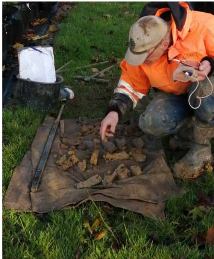
Afb. 2.12 Het beschrijven van een boring.
