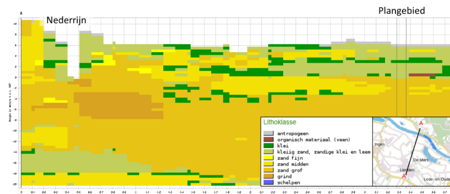
Figuur 2-2: Geohydrologische opbouw west - oost op basis van DINOloket, model GeoTOP v1.6 (2024)
