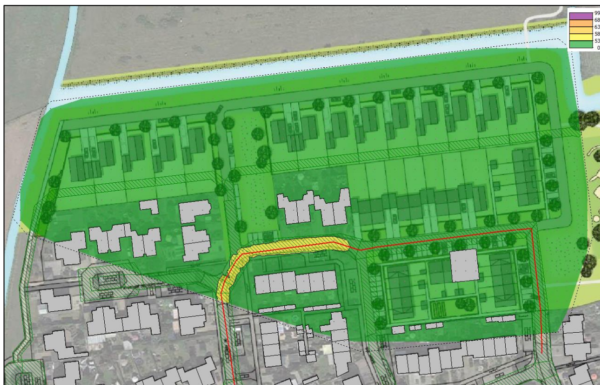
Figuur 4.1 Geluidsbelasting op 5 meter hoogte als gevolg van De Abdij
