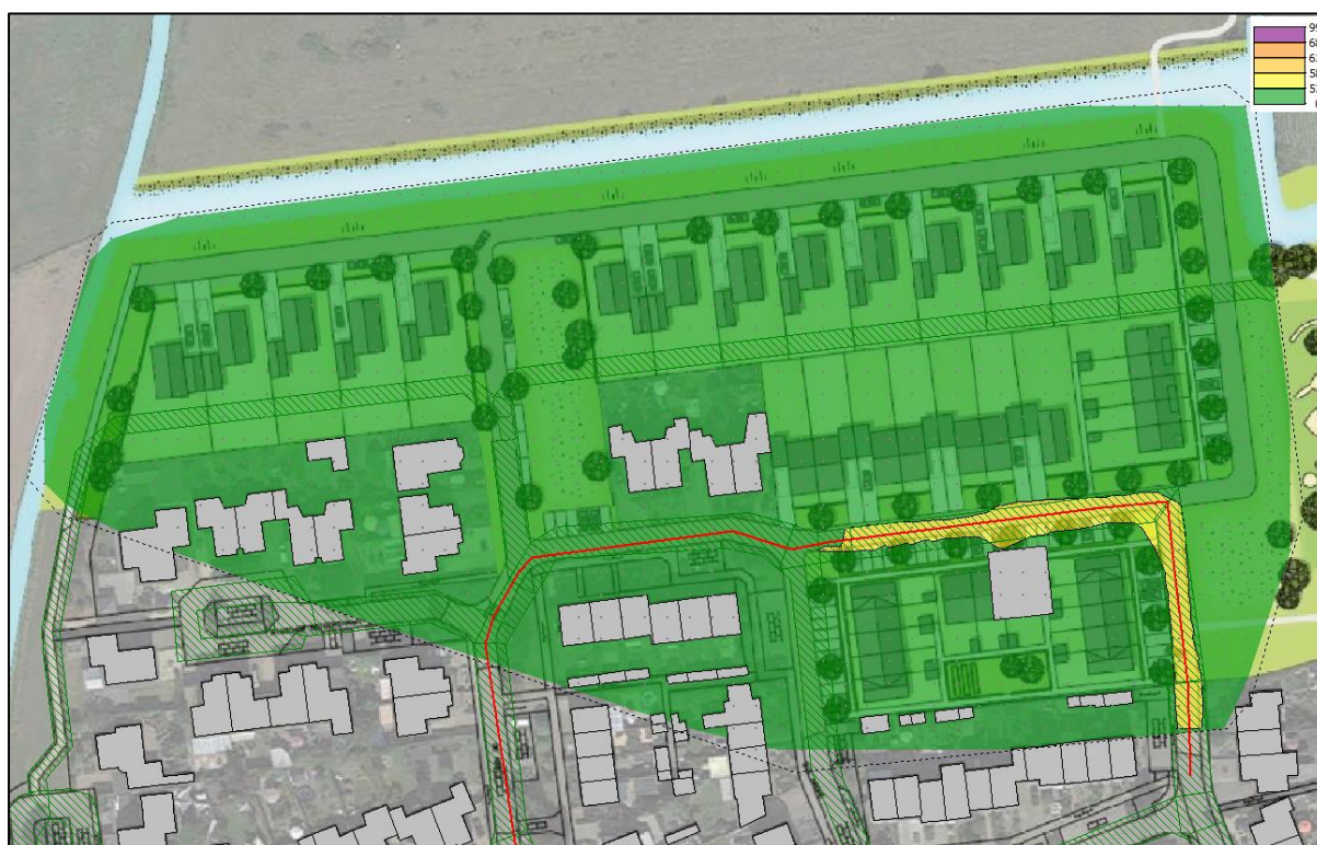
Figuur 4.2 Geluidsbelasting op 5 meter hoogte als gevolg van de Steenakkerstraat
