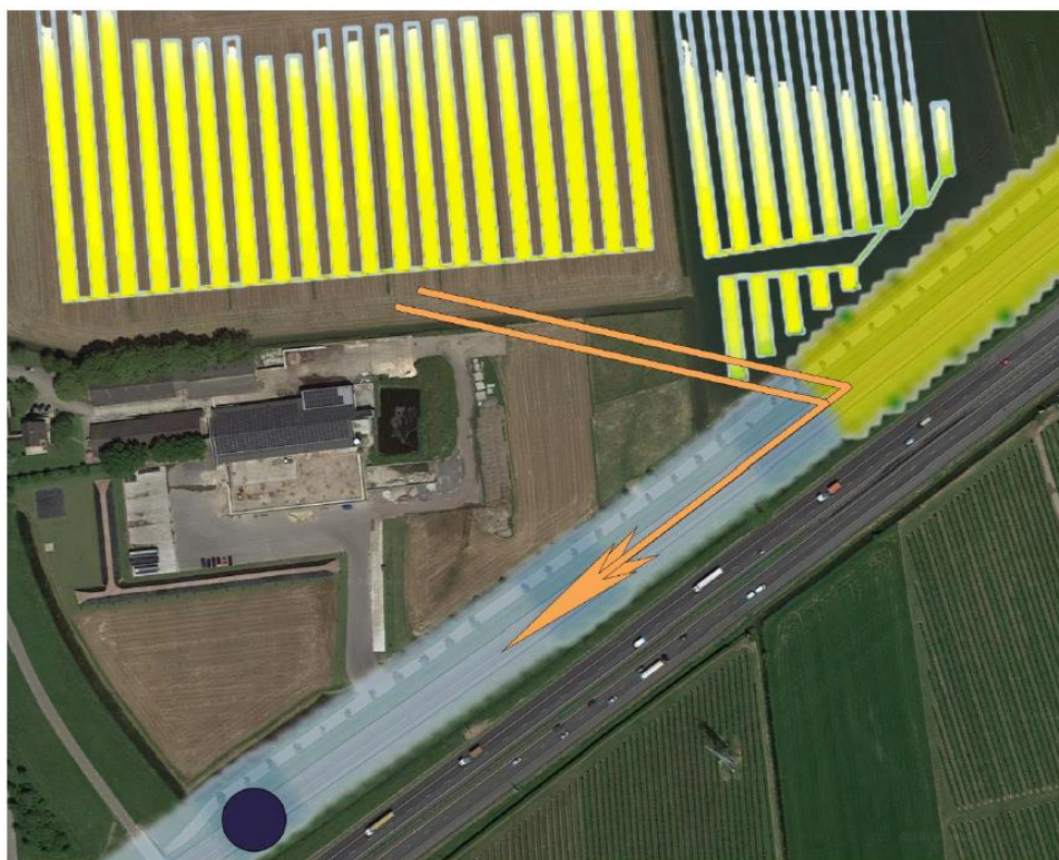
Afbeelding 26. Kritisch de el van de route waar reflectie ondervonden wordt, hoek rechter pijl: 361 meter van het stop marker board, linker pijl: einde hinder (bron: ROM3D).
