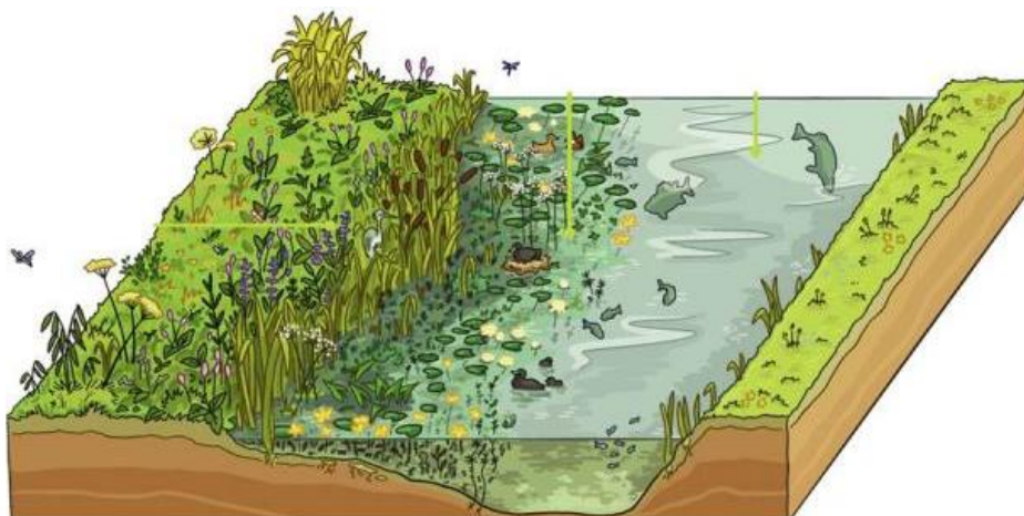
Afbeelding 5. Schematische weergave van een natuurvriendelijke oever aan een zijde van de waterloop. Bron: Waterschap Hollandse Delta.
