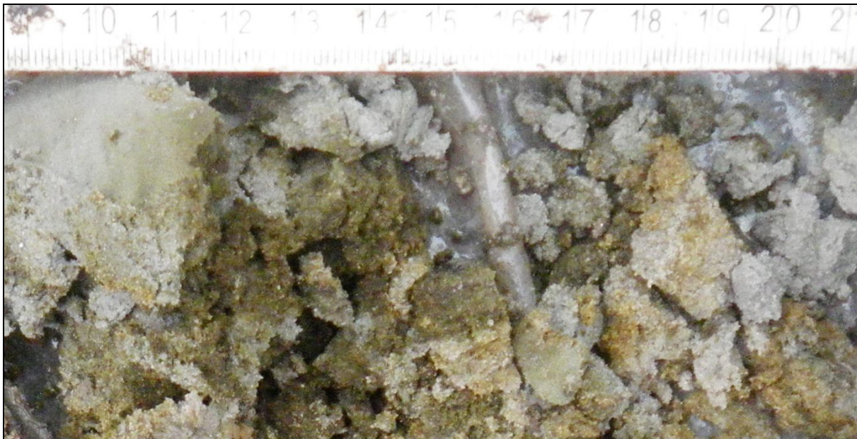
Figuur 10: Ingespoeld groengekleurd fosfaat in pakket 4 rond 2,4 m –mv in boring 2.
