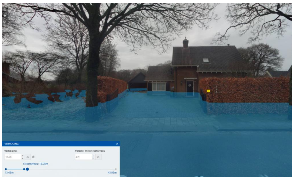
Figuur 4:1: Loubergweg 58 – onderzijde raam op 0,90m boven straatpeil
