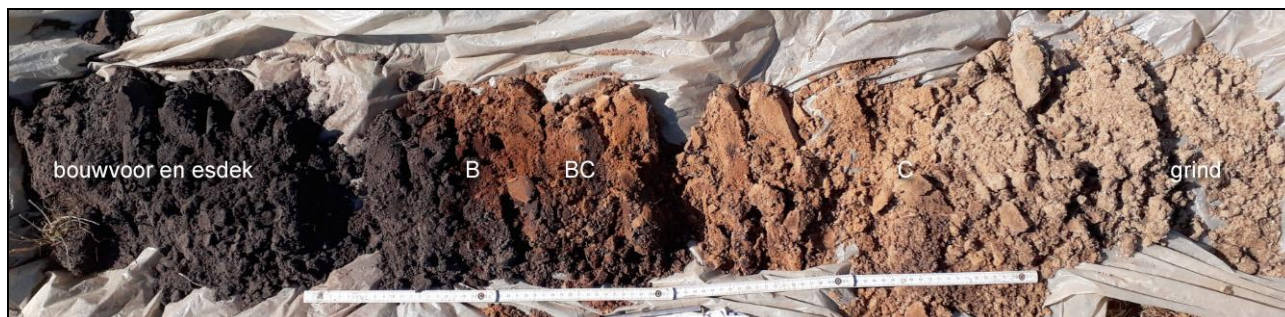
Figuur 7: De van links naar rechts uitgelegde boring 3. De schaalstok is 80 cm lang.
