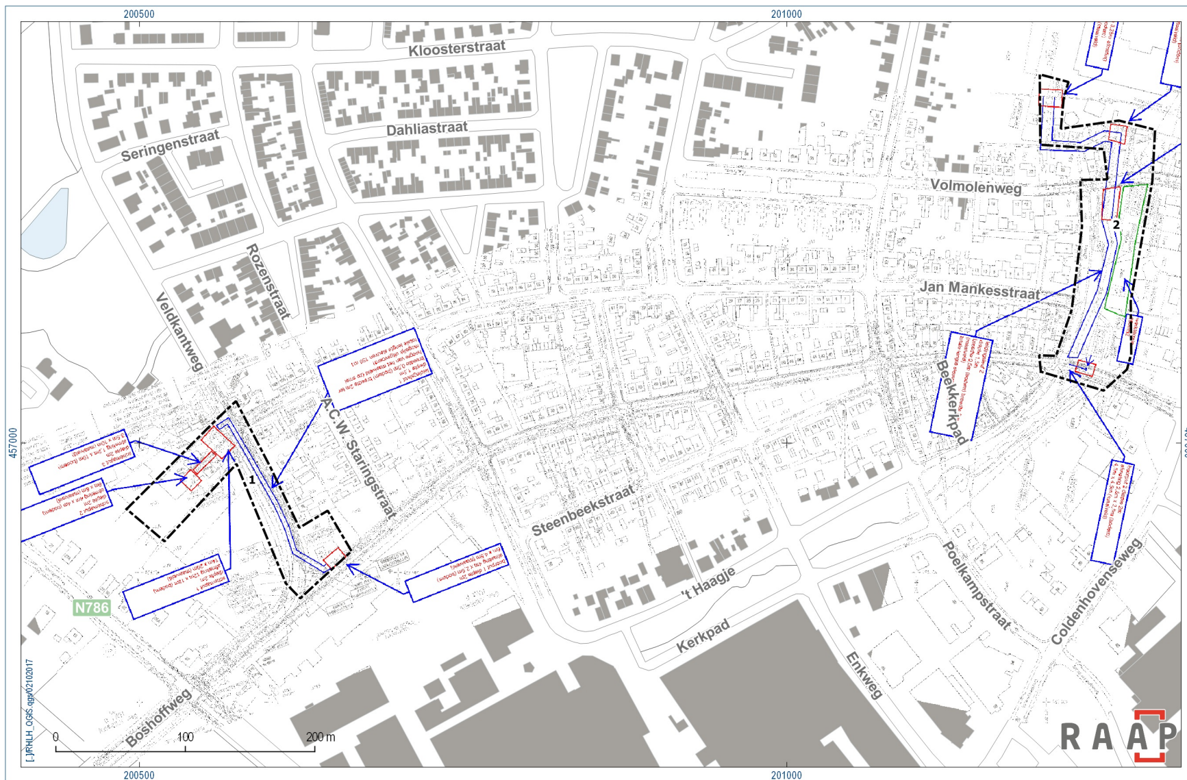
Figuur 2. Geplande werkzaamheden ten behoeve van de nieuwe gasleiding. In blauw de te ontgraven contour voor de nieuwe leiding en in rood de te ontgraven werkputten (bron: Gasunie).
