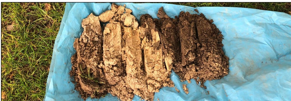
Boring 6: 0-50 cm -Mv, meermalen gestaakt in een zeer vaste puinlaag of leiding
