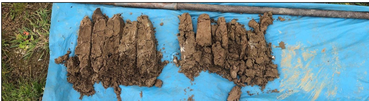
Boring 7: 0-100 cm -Mv., meermaals gestaakt in zeer vaste puinlaag.
