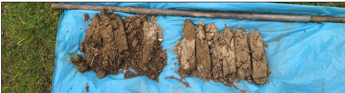
Boring 8: 0-100 cm -Mv, meermaals gestaakt in zeer vaste grindlaag
