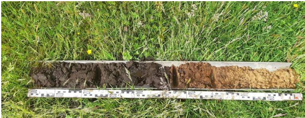
Afbeelding 17: Foto van het boorprofiel van boring 9 met v.l.n.r. de grijsbruine humeuze bouwvoor, de donkerbruine slibbig beekeerd, de oranjebruin gevlekte menglaag (A/B-horizont) en het lichtgrijze dekzand.
