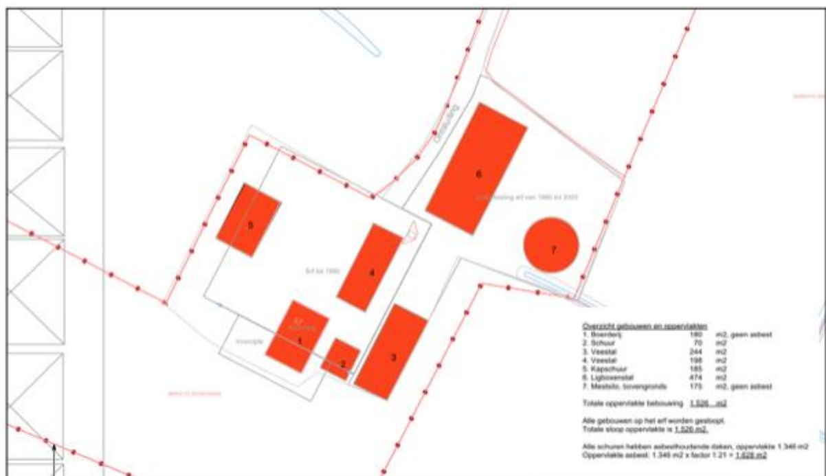
Afbeelding 2.2 De te slopen bebouwing (Bron: Groenadviesbureau H.A. ten Have)
