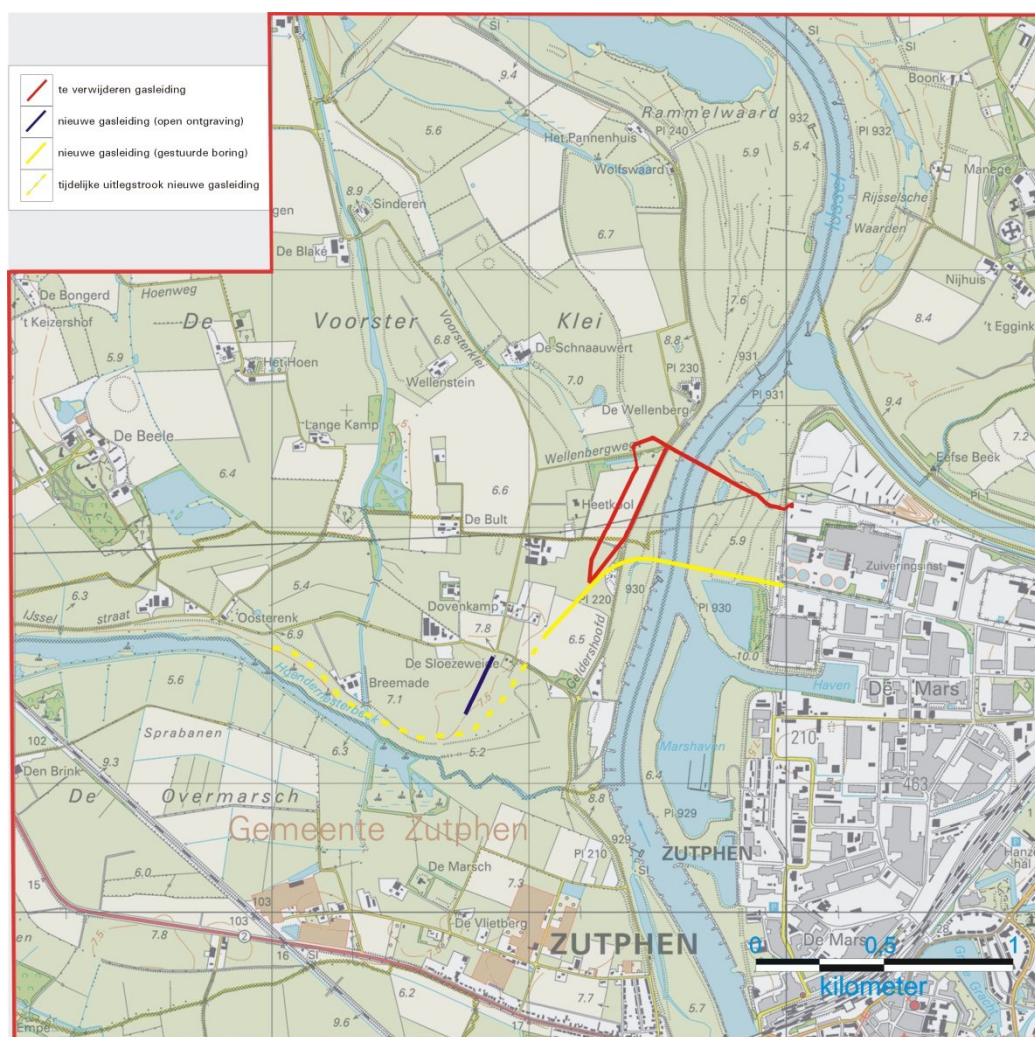
Figuur 1. Overzicht van de door Gasunie NV voorgenomen ingrepen ten westen van Zutphen.
