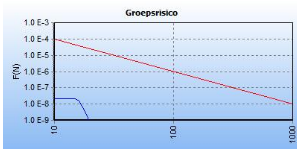
Figuur 7: FN curve van de kilometer met de hoogste overschrijdingsfactor (0,0) van de N-559-20 De ligging van de kilometer met de hoogste overschrijdingsfactor is hiernaast in het groen weergegeven op een topografische kaart.
