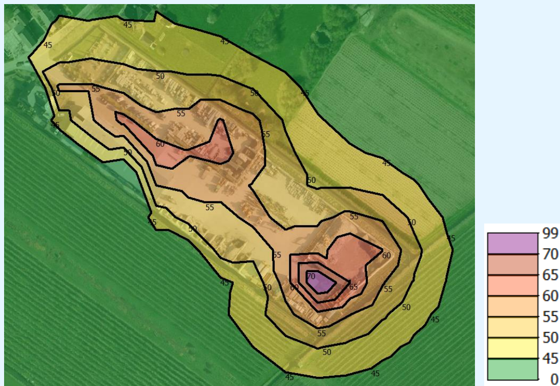
figuur 2: geluidscontour langtijdgemiddeld beoordelingsniveau dagperiode hoogte 1,5 meter
