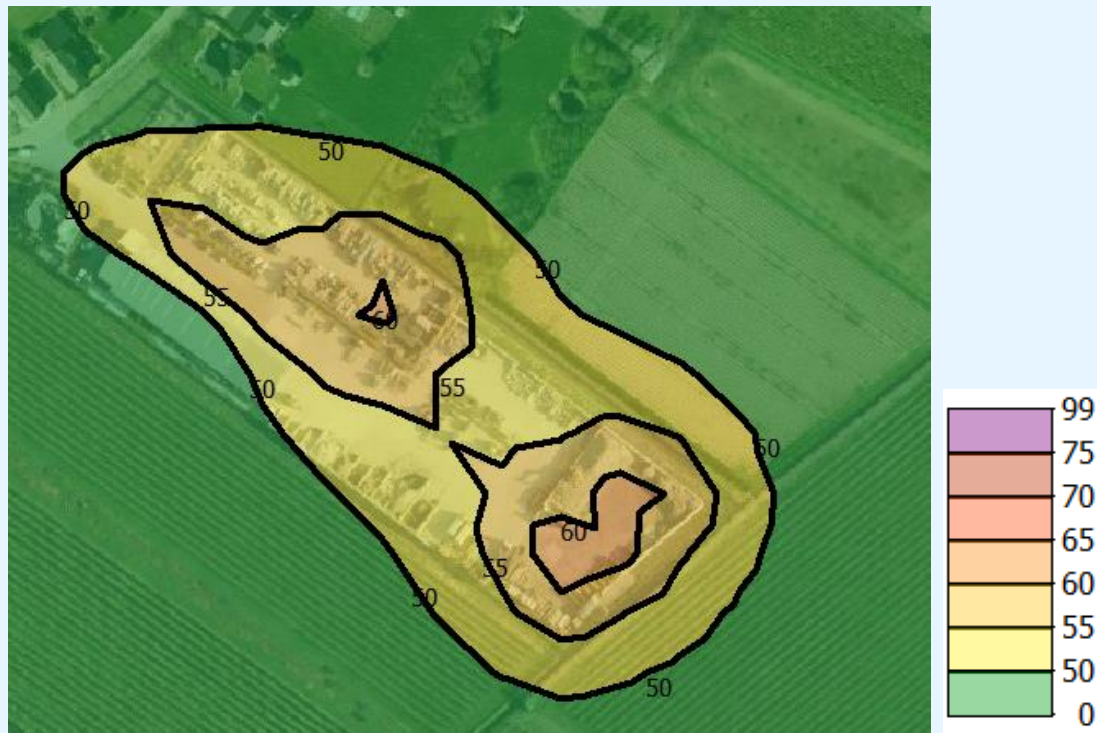
figuur 4: geluidscontour langtijdgemiddeld beoordelingsniveau dagperiode hoogte 8,0 meter
