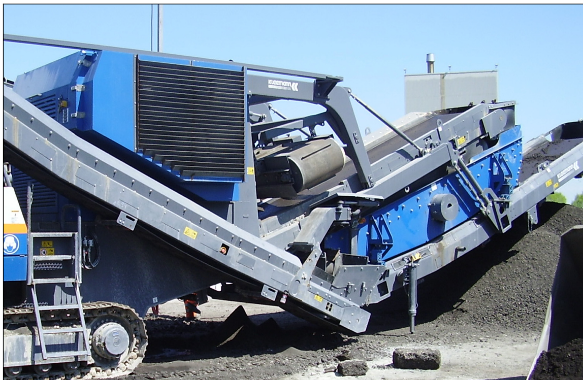
Afbeelding 5- Achterzijde installatie met links het motorcompartiment (met aangepast koelluchtrooster), in het midden de magneetband (met dwarsover de retourband) en rechts de zeefunit met afvoerband
