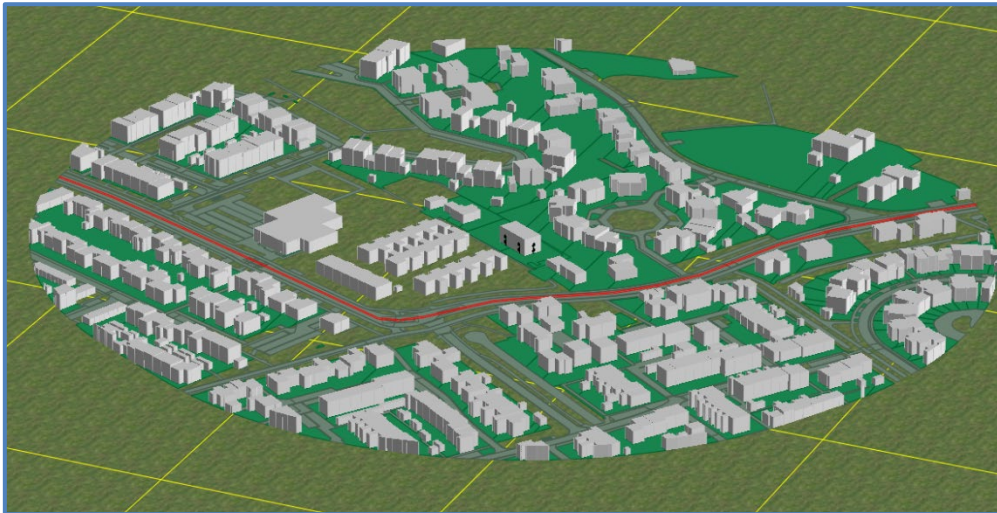
Afbeelding 4. Rekenmodel wegverkeerslawaaï, 3d-weergave
