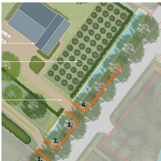
Fig. 24. Met oranje lijnen de afzetting met bouwhekken weergegeven t.b.v. Bescherming van de groeiplaatsen.
