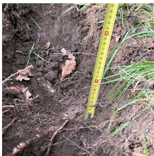
Fig. 13. & 14 Detail enkele dikkere boomwortels in proefsleuf 3 ca. 20 cm onder maaiveld. boomwortels zijn op deze locatie 3 cm dik.
