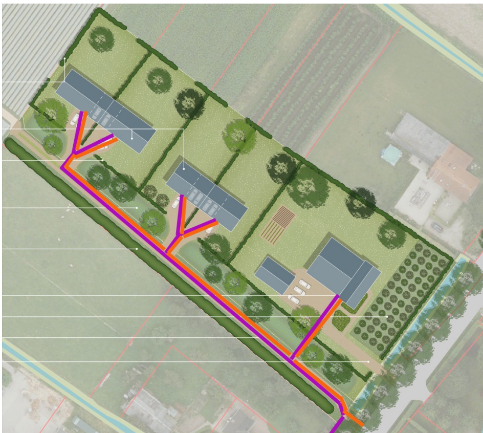
Fig. 26. Schematische weergave voor kabel & leiding tracé met minste impact voor gemeentelijke bomen. Met een paarse kleur het tracé voor het persriool. Met een oranje kleur het tracé voor water, gas, elektra en data (glasvezel).
