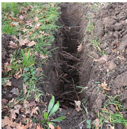
Fig. 10. Detail proefsleuf 2 met fijne beworteling in de bovenste 25 cm onder maaiveld.
