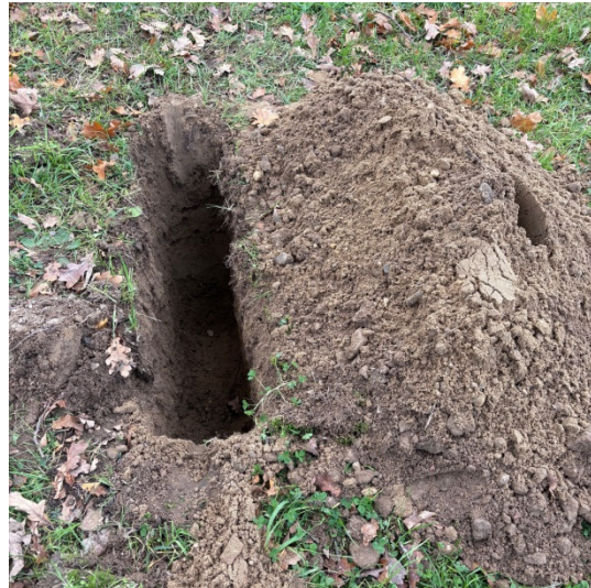
Fig. 16. Detail proefsleuf 4 geen beworteling
