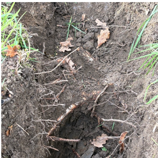
Fig. 13. & 14 Detail enkele dikkere boomwortels in proefsleuf 3 ca. 20 cm onder maaiveld. boomwortels zijn op deze locatie 3 cm dik.
