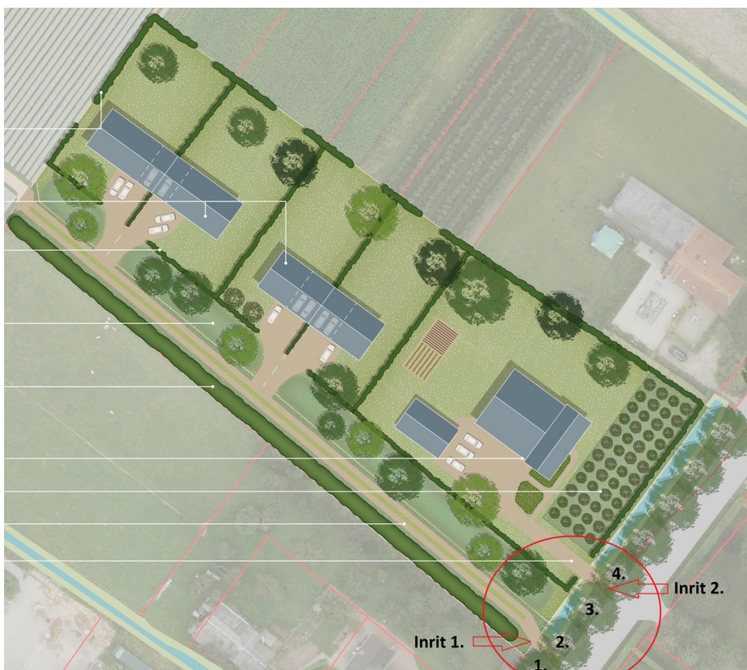
Fig. 21. Ontwerptekening met de woningen daarop ingetekend en de positie van het nieuwe inritten. Ontwerptekening ontvangen vanuit opdrachtgever Buro Waalbrug. De gemeentelijke bomen zijn aangeduid met de nummers 1 t/m 4.
