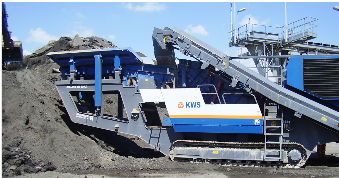
Afbeelding 4- Achterzijde installatie met links de doseur met voorafscheider, midden de breker, rechts het motorcompartiment en dwarsover de retourband
