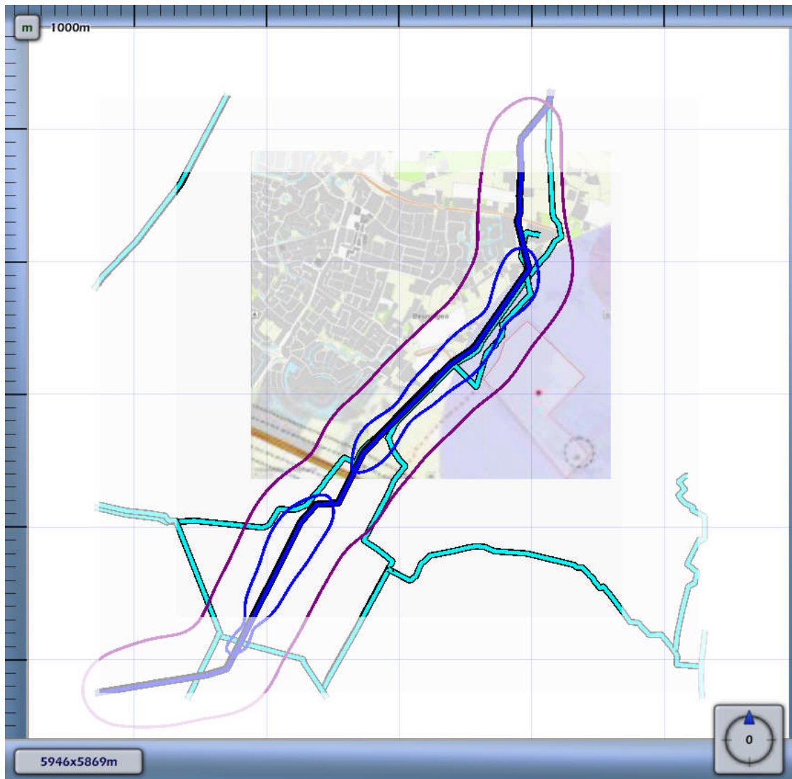
3.4 Figuur 3.4 Plaatsgebonden risico voor A-533 van N.V. Nederlandse Gasunie
