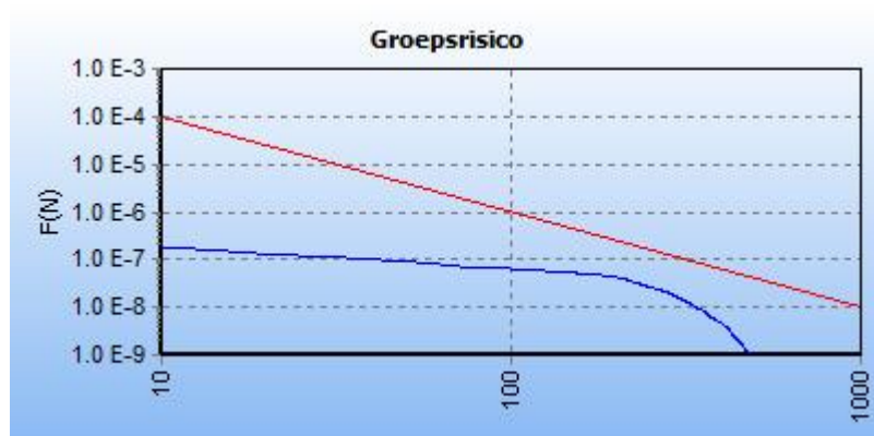
Figuur 5.2 FN curve voor 9030_leiding-A-507-deel-1 van N.V. Nederlandse Gasunie voor de kilometer tussen stationing 4170.00 en stationing 5170.00
