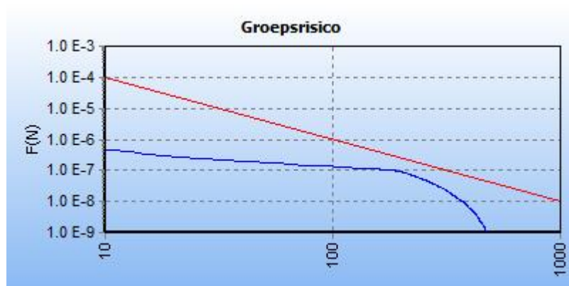
Figuur 5.2 FN curve voor 9030_leiding-A-507-deel-1 van N.V. Nederlandse Gasunie voor de kilometer tussen stationing 4170.00 en stationing 5170.00
