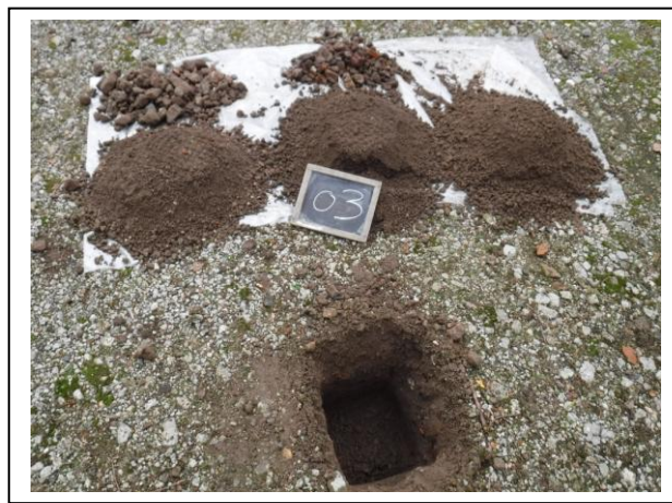
Foto 2. Asbestinspectiegat + Opgegraven en gezeefd materiaal gat 03
