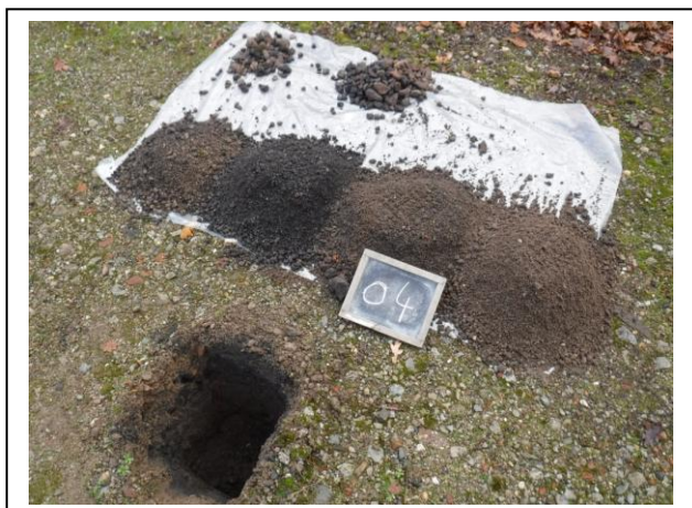
Foto 3. Asbestinspectiegat + Opgegraven en gezeefd materiaal gat 04
