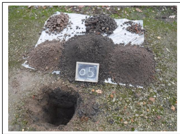
Foto 4. Asbestinspectiegat + Opgegraven en gezeefd materiaal gat 05
