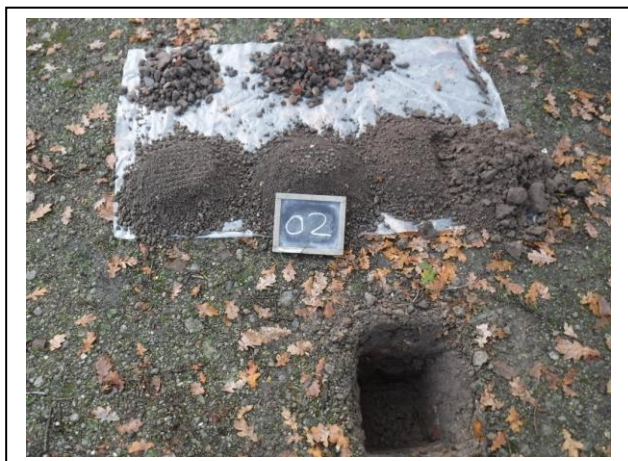
Foto 1. Asbestinspectiegat + Opgegraven en gezeefd materiaal gat 02
