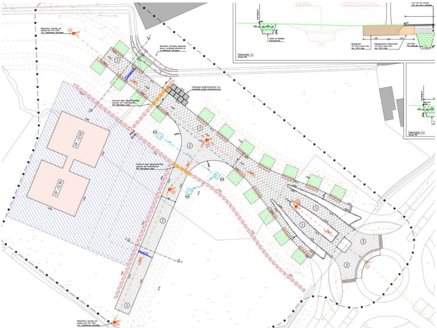
Figuur 17 Uitvoeringsontwerp vuilwaterriolering tijdelijke huisvesting
