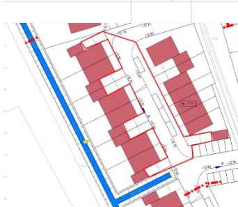
Figuur 18 Gootberekening en locatie zwaarst belaste goot (excl dakverharding i.v.m. eigen bergingsvoorziening)
