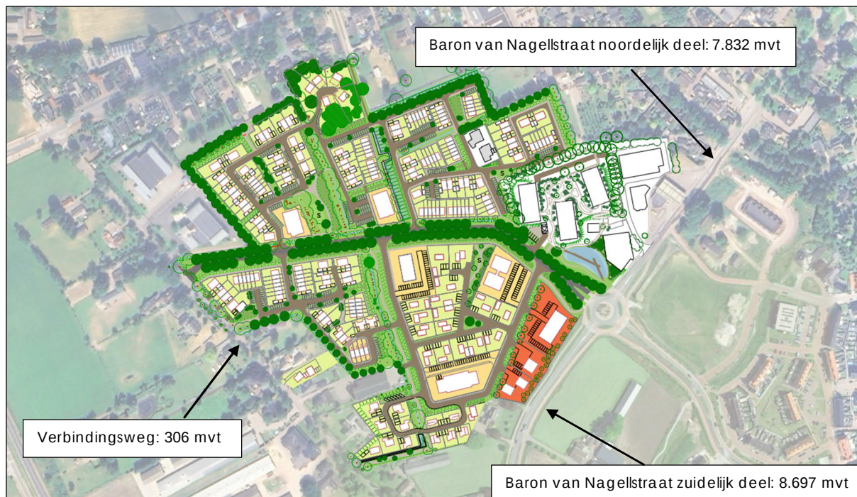
Afbeelding 3: Verwachte verkeersintensiteiten in autonome situatie
