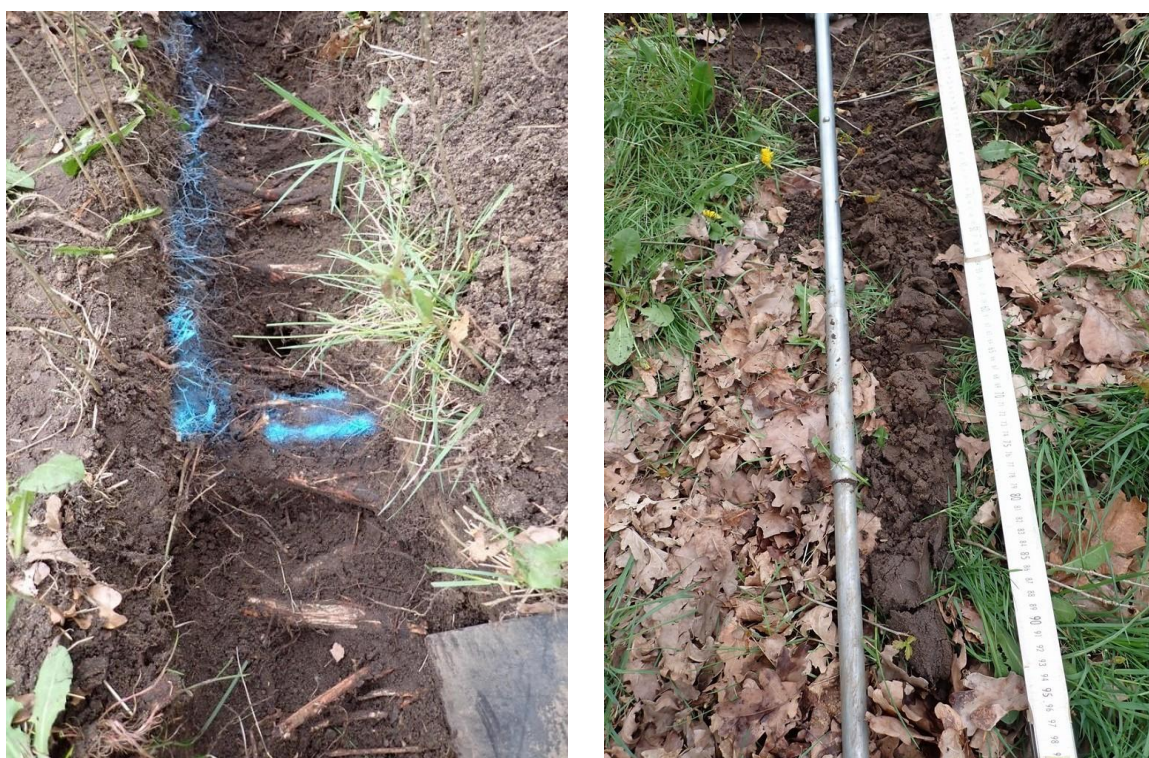
Figuur 16: Proefsleuf op 3 meter ten zuiden van boom 22, met fijne en middelfijne beworteling (links) en het bodemprofiel tussen 70 en 100 cm onder het maaiveld (rechts).
